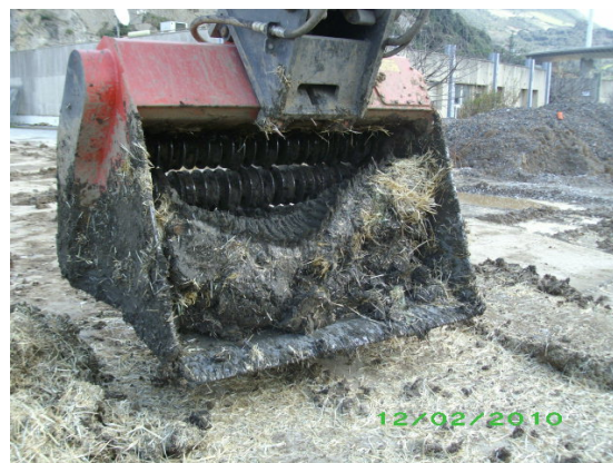
Fig. 40. Pala con material atascado que era necesario reprocessar
