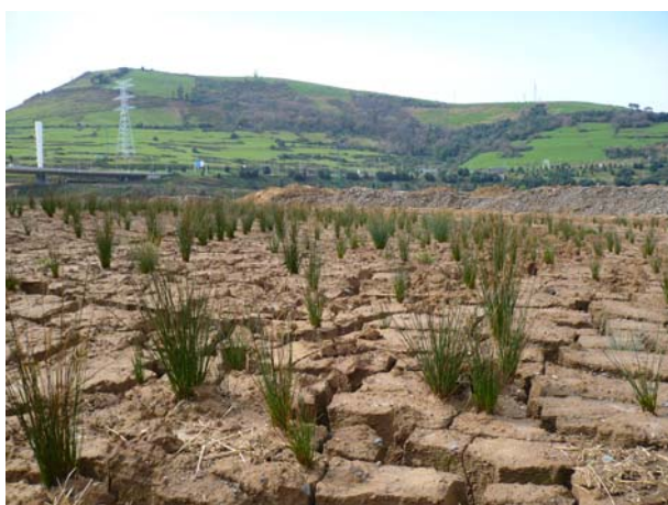
Fig. 38. Material empleado en su acopio original, se observa su carácter plástico
