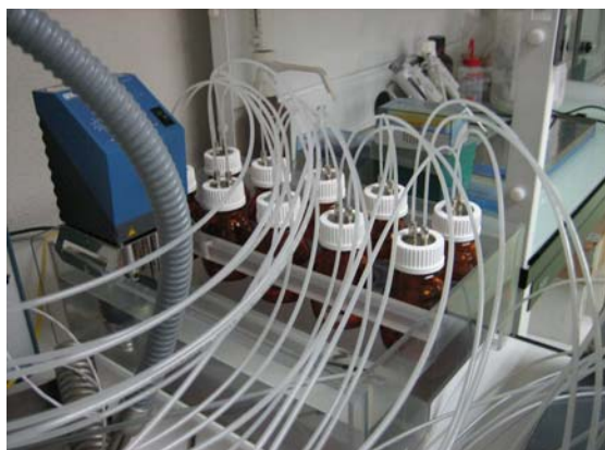
Fig. 3. Detalle del experimento de biotratabilidad en fase sólida húmeda
